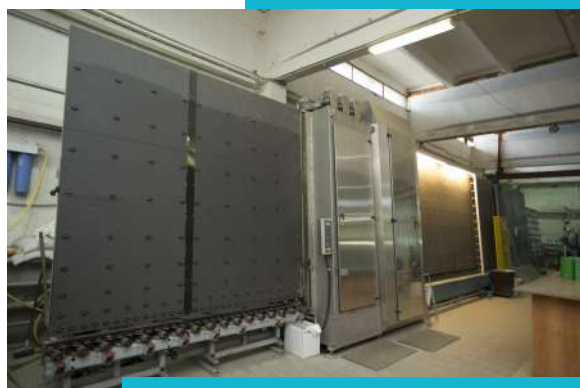
Линии сборки стеклопакетов LISEC
